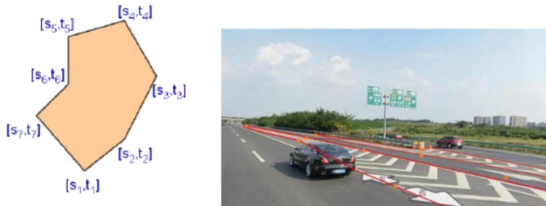
图 33 导流线区示例图
